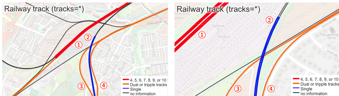
Abbildung 22: fehlerhafte Repräsentation der Gesamtzahl paralleler Gleise mit dem tracks -Attribut (links Zoom 15, rechts Zoom 17; Karlsruhe-Weiherfeld) [cf. ito12]
