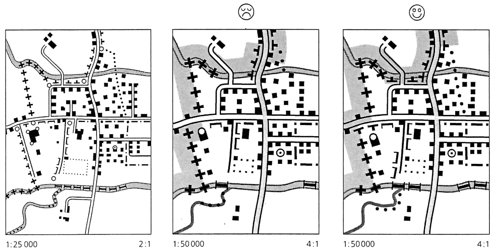
Abbildung 27: Generalisierung des Grenzverlaufs entlang physischer Objekte [© sgk02, 83, entsättigt und verkleinert]
