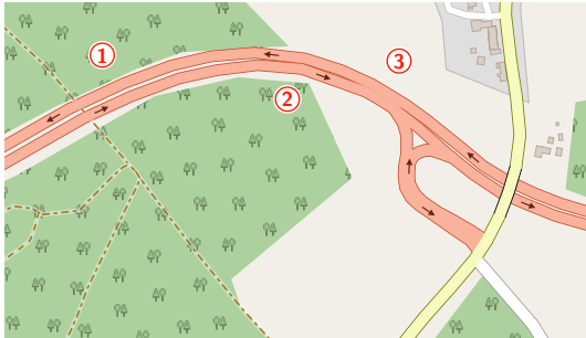
Abbildung 18: variierende Abstände von Richtungsfahrbahnen [osm18, bearbeitet]
